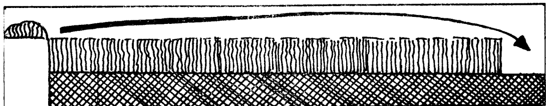
Gambar 11. Pada bagian ke 10, tanah topsoil pada bagian pertama dimasukkan ke tempat yang kosong pada bagian 10.
